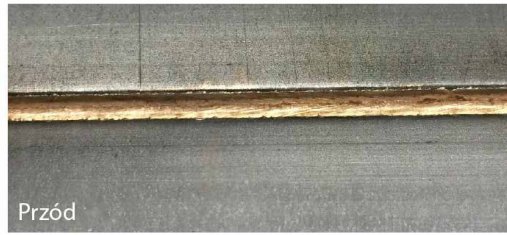
Lutowane laserowo komponenty dachu pojazdu od strony przedniej i tylnej
