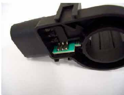
Przykłady lutowania laserowego komponentów elektronicznych
